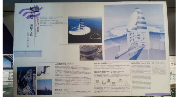
환기 및 실드 TBM의 시작점으로 사용 중인 KAZENO TOU
